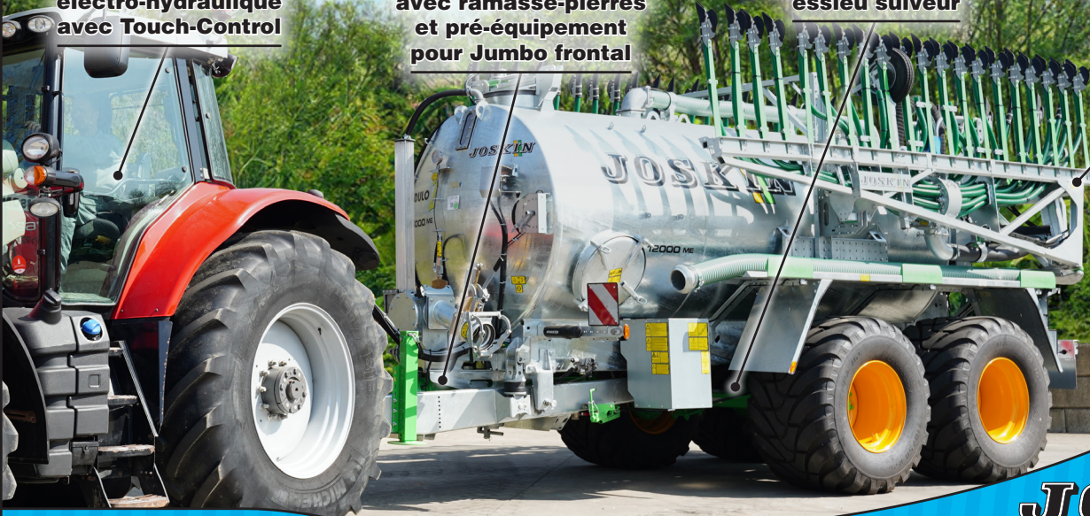
Boggie Roll-Over avec essieu suiveur
